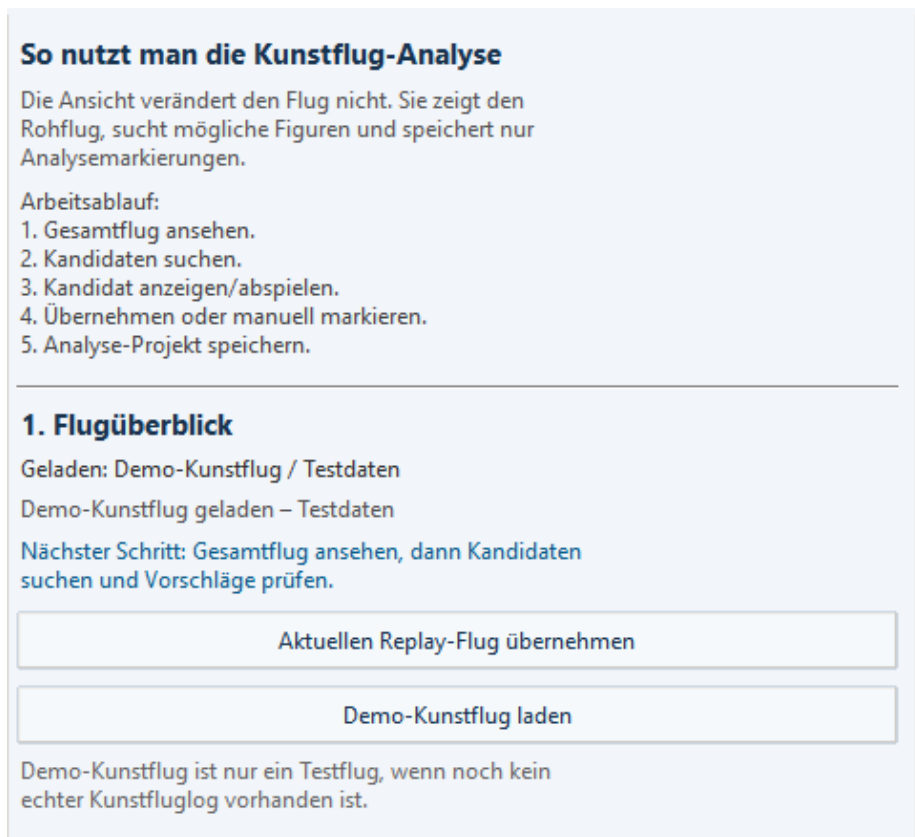
Abbildung 1: Einstieg in die Kunstflug-Analyse mit Anleitung, Flugüberblick und Schaltflächen zum Übernehmen des Replay-Flugs oder Laden des Demo-Kunstflugs.
